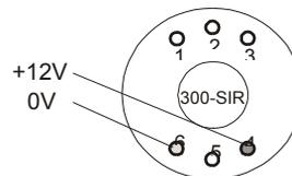
Kopling av 300-SIR sirene i system med IMC-M sentral og 300-RE røykdetektorer:
