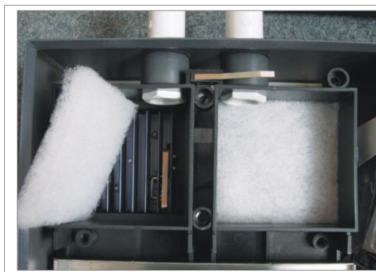
Bilde 7 – Filter och värme-element
