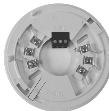
Fig 3: Reläsockel(7=Nc, 8=Com, 9=No)
