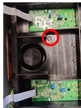
Figur 3: Vifte, løsne skrue
